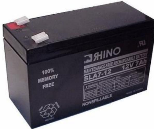
L'astuce est de choisir des batteries qui supportent un taux C20 de fonctionnement du moteur : ce taux est la référence Ampère-heure de la batterie divisée par 20. L'ampère-heure est le courant que peut fournir la batterie pendant une heure. Si la batterie fournit un courant trop élevé, alors elle se dégradera plus vite.
